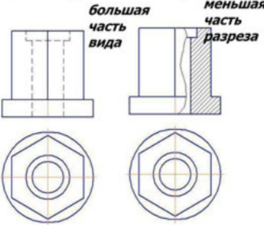
*Часть вида и часть разреза разделяют сплошной волнистой линией.*
